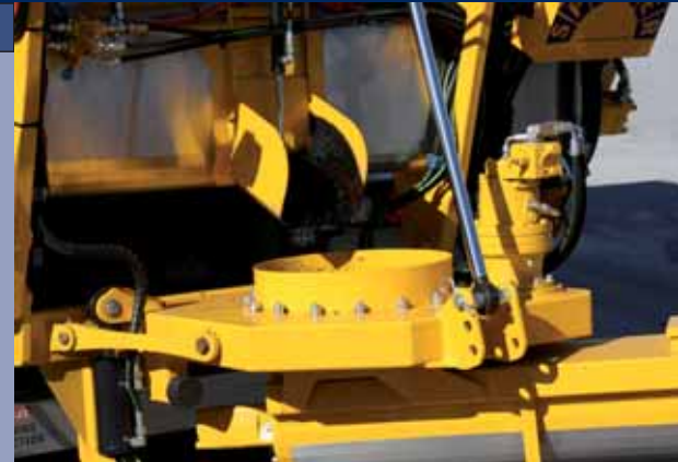
Wormwiel achter de deur brengt het asfalt naar de eerste balk.
